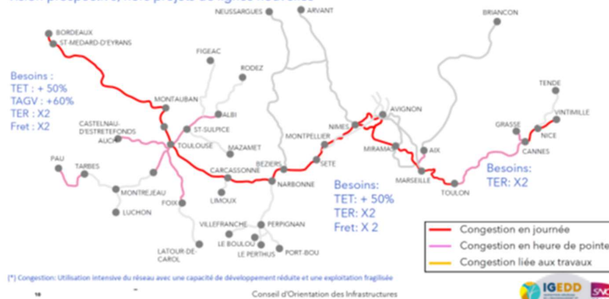
Figure 20 : Perspectives de congestion des lignes ferroviaires à 10 ans, sur le périmètre de la plateforme Grand Sud (source : SNCF Réseau)
